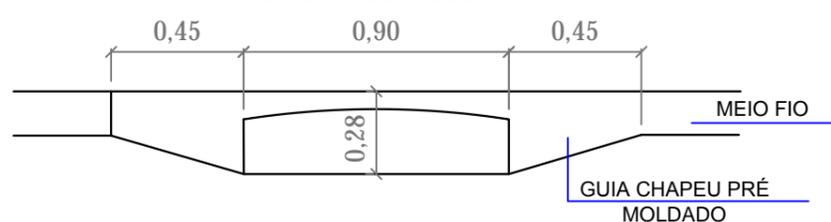
DIMENSÕES DA CAIXA DE CAPTAÇÃO
