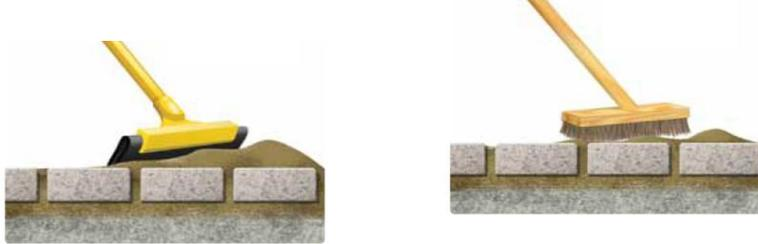
Antes da liberação para o tráfego de pessoas ou equipamentos verificar se a superfície acabada não está com desnível entre as peças.
