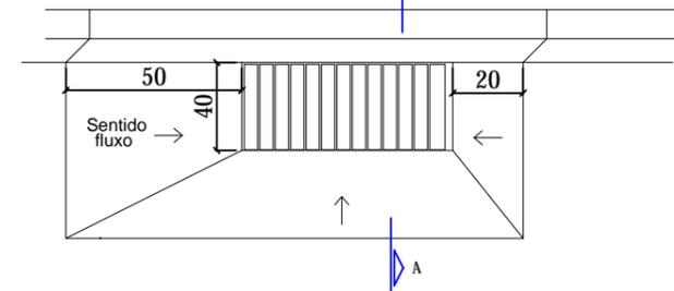
DIMENSÕES DA CAIXA DE CAPTAÇÃO
